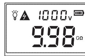
4. 松开测试键，此时仪器会自动释放测试所产生的高压，高压指示灯灭，高压警报“嘀、嘀”声消失，待LCD屏幕显示“0V”时方可拆除表笔线，此时LCD屏幕显示测试的绝缘电阻值，如下图所示：
