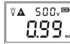
直至把测试按钮以逆时针方向旋转并且将它恢复到原来的位置，高压指示灯灭，高压警报“嘀、嘀”声消失，仪器将一直处于测量状态，解除测量按钮后仪器会自动释放测试所产生的高压，待LCD屏幕显示“0V”时方可拆除测试线，此时LCD屏幕显示如下图所示：
