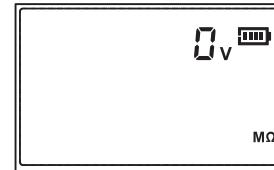
3. 把测试表笔或夹子连接到被测物，按下测试旋钮，进入测试状态，此时蜂鸣器会间歇地发出“嘀、嘀”声，高压指示灯亮，测量过程中LCD屏幕显示以下内容：
